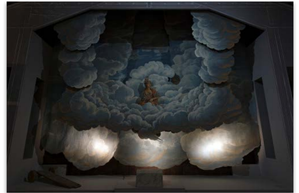
Reconstitution d'une « Gloire » et de sa machinerie spécifique. Une Gloire est le nom donné à une nacelle qui descend des cintres sur des nuages mouvants pour magnifier un personnage figurant une divinité. © Château de Versailles, Didier Saulnier
