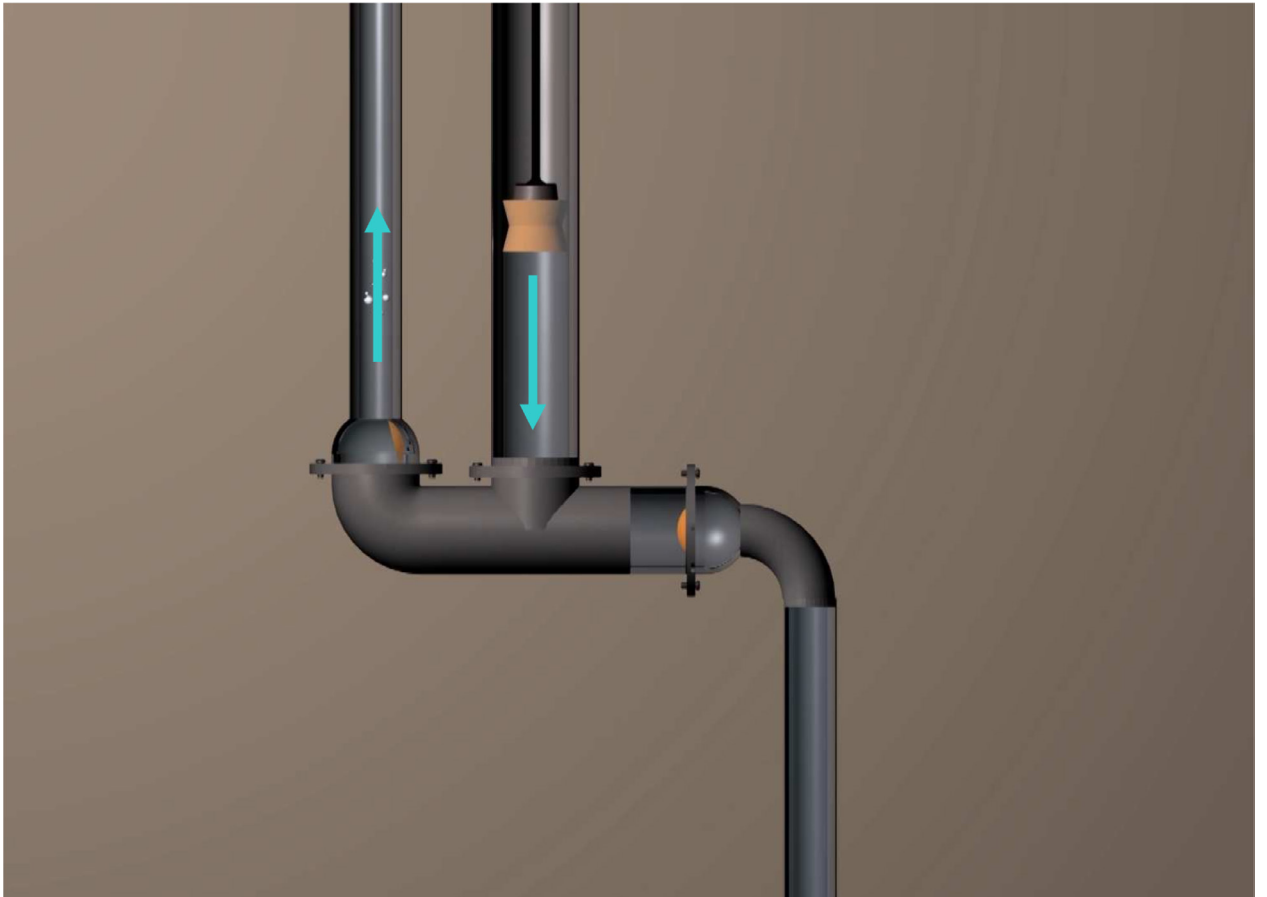
Illustration 3 : Le piston est poussé vers le bas. Cela crée une compression qui ouvre la soupape B et ferme la soupape A. L'eau est refoulée dans le tuyau montant. Capture d'écran de la vidéo « Fonctionnement d'une pompe aspirante et refoulante ». © Chateau de Versailles, copie d'écran d'une vidéo réalisée par David Pendery
