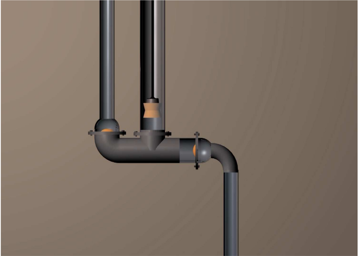
Illustration 4 : Le piston est à nouveau en position basse. Le cycle reprend avec l'illustration 2. Capture d'écran de la vidéo « Fonctionnement d'une pompe aspirante et refoulante ».
